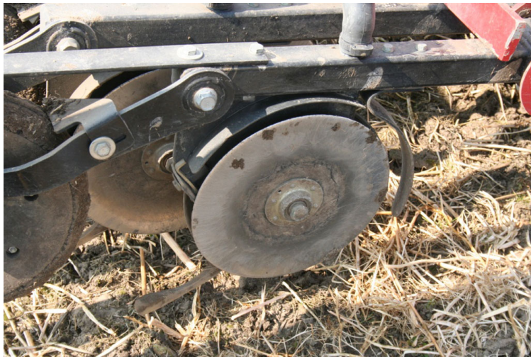
Foto 4. I forsøg- og forskningsopgaver med direkte såning bør der være nøje beskrivelse af bl.a. såskærets udformning, lukningen af sårillen og mængden af afgrøderester. Foto: Janne Aalborg Nielsen, VFL.
